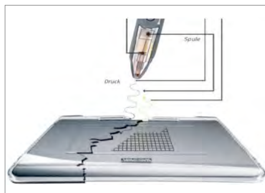
Rechts: Darstellung der technischen Konstruktion des Tablett
